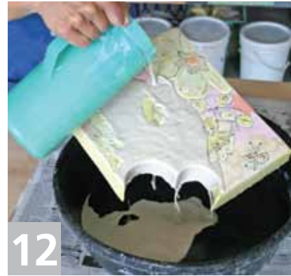
12 Pour clear glaze over the surface.
